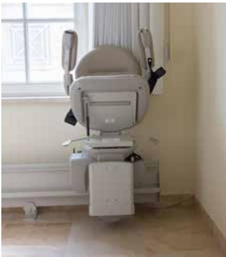
Le design compact du Diamant permet d'économiser de l'espace pour une circulation parfaite de l'escalier. Le rail fin peut être monté jusqu'à 127 mm du mur et une fois les accoudoirs, le siège et le repose-pieds relevés, le Diamant ne prend que 425 mm d'espace.
